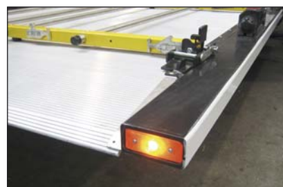
S708 Сигнальные фонари, смонтированные на платформе
