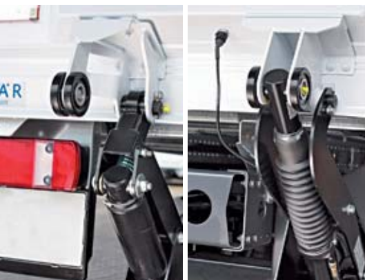
Подъемное плечо (слева) и несущее плечо (справа) с защитными элементами и пыльниками
